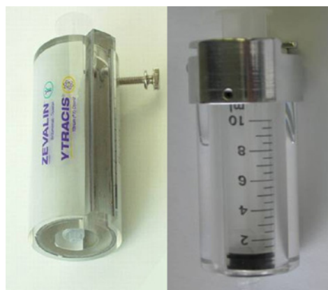
Abb. 2: Abschirmungen für 10 ml-Spritzen a: mit Blei-Inlay, b: ohne Blei-Inlay
