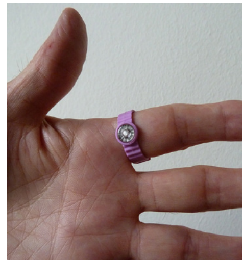
Abb. 6: Empfohlener Trageort des amtlichen Beta-Photonen-Fingerring-Dosimeters
