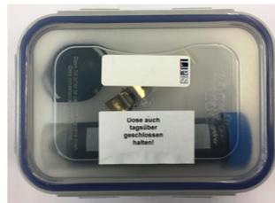
Die Radonbox enthält neben dem Exposimeter auch ein Aktivkohleröhrchen. In Kombination einer geschlossenen Radonbox und dem Aktivkohleröhrchen wird die Radonkonzentration in der Radonbox um > 90 % gegenüber der Radonkonzentration aus der Umgebung reduziert und es kann auf ein Referenzexposimeter verzichtet werden.
