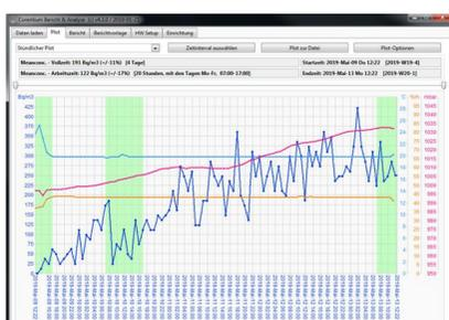
Die Abbildung zeigt den Anstieg der Radonkonzentration in Zeiten mit fehlender Belüftung (weiß hinterlegt) bzw. bei vorhandener Belüftung (grün hinterlegt).
