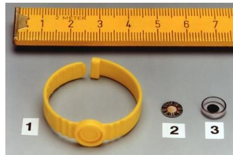
Der TLD-Detektor wird zusammen mit der Abdeckung von der Personendosismessstelle in den Einweg-Ring gepresst, so dass keine scharfen Kanten sowie keine Zwischenräume entstehen und somit keine Flüssigkeiten eindringen können. Der Einweg-Ring wird nach der Auswertung nicht wieder verwendet. Der Einweg-Ring ist in der Größe verstellbar.
